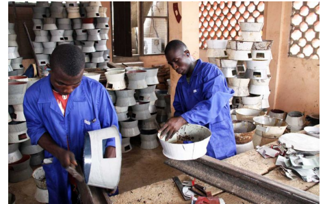
Herstellung von Ofenkörpern im Produktionszentrum in der Nähe von Accra. Foto: Toyola Energy Services Limited
